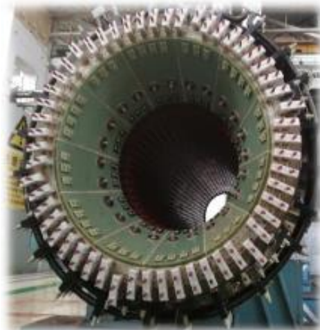
Slika 2.2: Savremena tehnologija krutog učvršćenja zalivanjem u eposkidnu smolu
