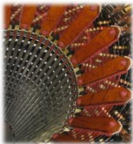
Slika 2.1: Klasična tehnika učvršćenja glava namotaja priteznim trakama
